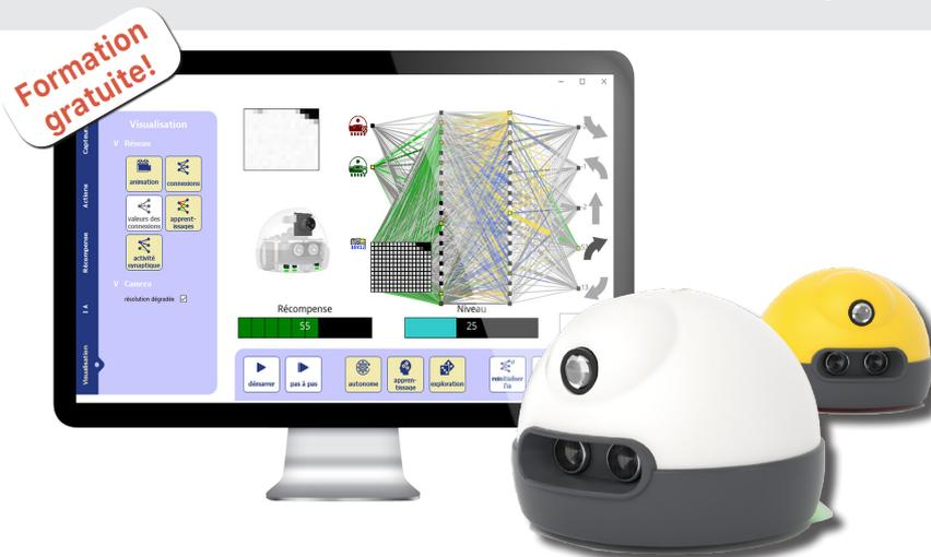
Le robot nommé AlphaI, intègre différents capteurs (caméra, échographe, infrarouge). Il est programmé avec Python sur une base de développement Raspberry.
