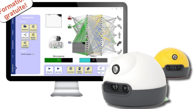
Le robot nommé AlphaI, intègre différents capteurs (caméra, échographe, infrarouge). Il est programmé avec Python sur une base de développement Raspberry.
