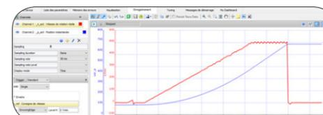
Le support de formation **Process Rapide** issu d'un process industriel de production de cartes bancaires est une machine comprenant un axe linéaire animé par un **moteur BRUSHLESS** et permettant le tri de cartes au format «carte bancaire» par **caméra dimensionnelle** et capteur RFID.
