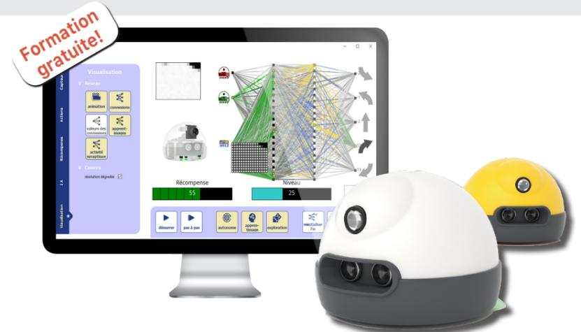
Le robot nommé AlphaI, intègre différents capteurs (caméra, échographe, infrarouge). Il est programmé avec Python sur une base de développement Raspberry.
