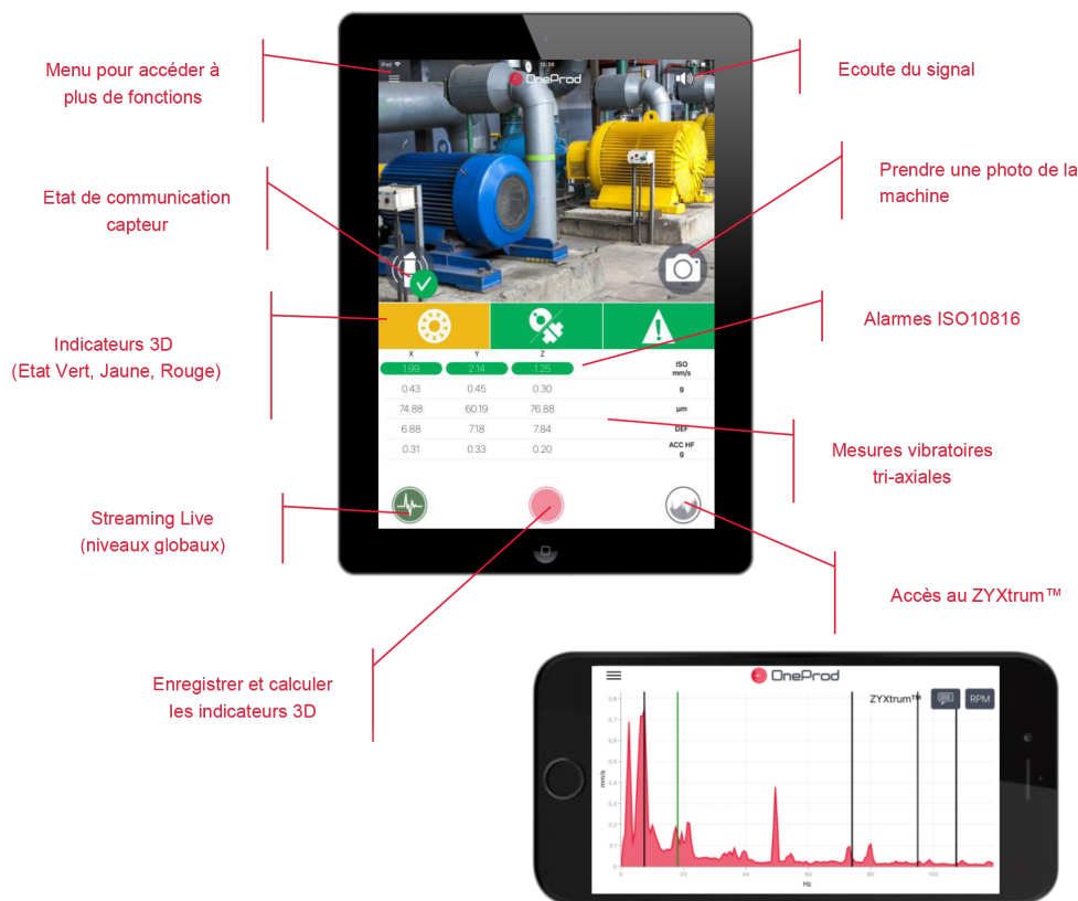
Exemple de défaut de roulement: l'un des fréquences de défaut roulement correspond à un pic
