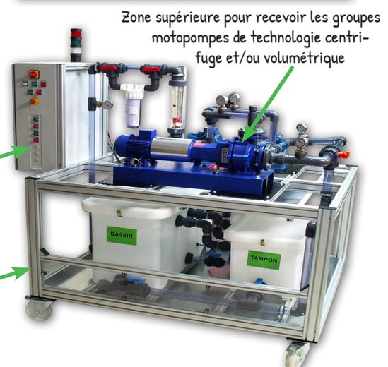
Zone supérieure pour recevoir les groupes motopompes de technologie centrifuge et/ou volumétrique
