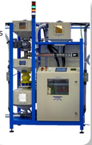
**Ensacheur** : Conditionne le mélange dans des sacs de 1,5 Kg ou 4 Kg :
