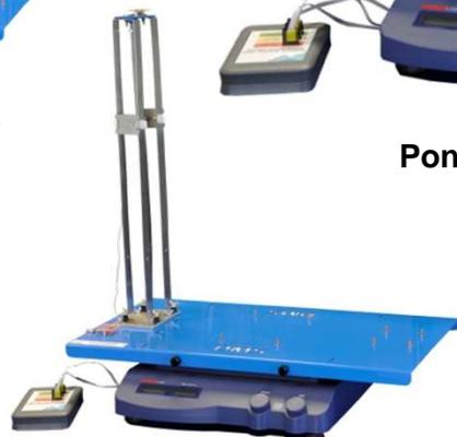
Structure à étages avec raidisseur sur rotules élastique
